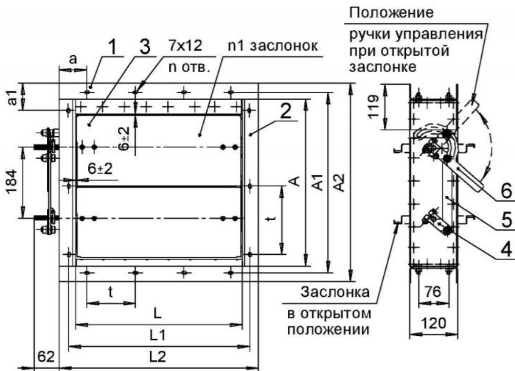
Рисунок 1 - Заслонка взрывозащищенная АЗД-ВЗ 193 (с ручным управлением) 1. Поперечина, 2. Стойка, 3. Заслонка, 4. Рычаг, 5. Тяга, 6. Ручка управления
